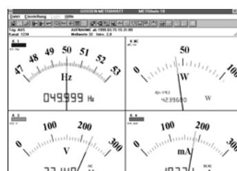
Die übertragenen Messwerte von maximal vier Kanälen werden im Online-Betrieb am Bildschirm digital mit eingeblendetem Analogskala oder als Analog-Zeigerinstrument mit einblendbarer Digitalanzeige dargestellt.
