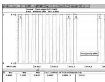
Die erfassten Messwerte von maximal vier Kanälen werden am Bildschirm als Liniendiagramm mit horizontaler Zeitachse dargestellt und mit zwei Zeigern vermessen. Gespeicherte Signale lassen sich in Amplitude und Zeitachse dehnen („Lupe“) bzw. komprimieren. Die Zeitskala ist in relativer Messzeit darstellbar.
